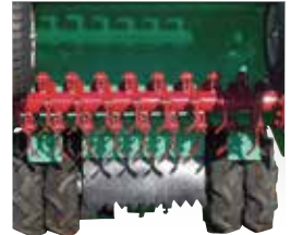
ハンマーナイフは熱処理を施した特殊強靱鋼を使用し、良く切れ、耐久性があります。取り付けはナイフが逃げるフリー構造です。
