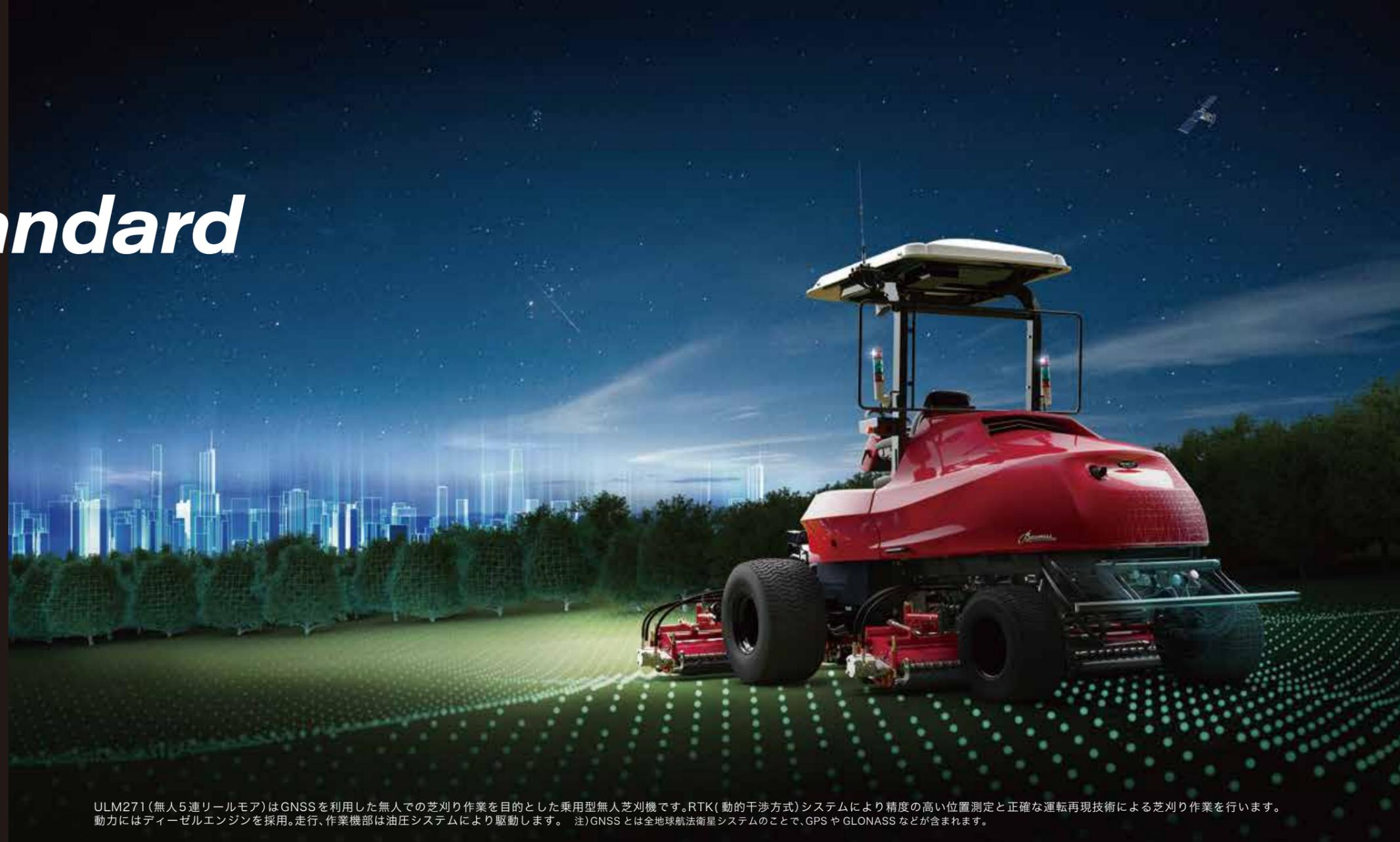
ULM271 (無人5連リールモア)はGNSSを利用した無人での芝刈り作業を目的とした乗用型無人芝刈機です。RTK(動的干渉方式)システムにより精度の高い位置測定と正確な運転再現技術による芝刈り作業を行います。動力にはディーゼルエンジンを採用。走行、作業機部は油圧システムにより駆動します。注)GNSSとは全地球航法衛星システムのこと、GPSやGLONASSなどが含まれます。
