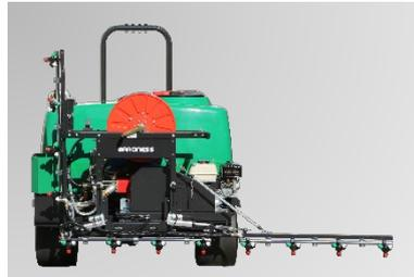
三つ折りブームは、左右別駆動の電動開閉式です。最大散布幅は5.4mです。
