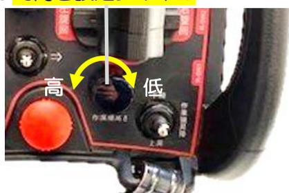
ダイヤルを回してモアの刈高さを調整します。
