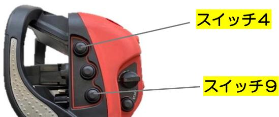
スイッチ9を長押ししながら、スイッチ4を押すと⑭で変更した値を変更前の状態に戻す事（クリア）ができます。クリアされると、ランプ赤・黄・白が点滅します。
