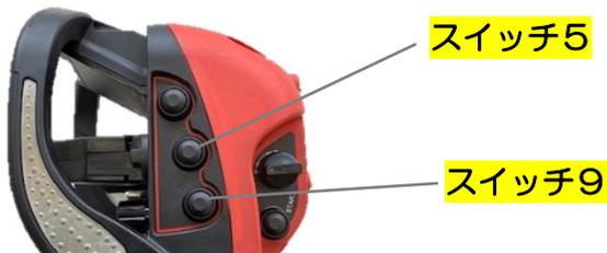
スイッチ9を長押ししながら、スイッチ5を押すと⑭で設定した調整値を保存できます。保存されると、ランプ赤・黄・白が点灯します。調整値を保存すると、電源を落としても値が保持されます。
