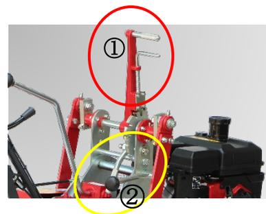
芝生の切り取り深さを①の深度調節ストッパーで、切り込み角度を②の角度調節締め付けハンドルで簡単に調整できます。芝の排出がうまくいかない時に、切り込み角度を調整することで芝が丸まってしまうことを防ぎます。
