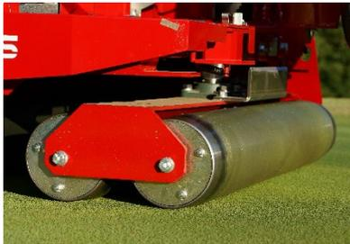
大径ローラー（操舵輪）の採用により接地圧の集中化を防ぎ、グリーン面を傷めません。グリーンの地面をならし、パッティングクオリティを向上させます。
