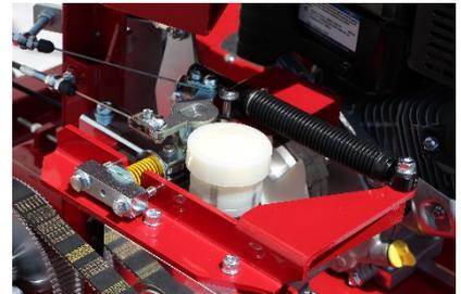
ダンパーシステムを採用することで作業時の急停止を抑制し、グリーンの端々を傷めません。ペダルを離せばすぐに走行が停止する現象をあえてなくしました。（調整可能）
