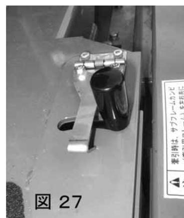
サブフレームカンビ（牽引用フレーム）の先端部をゆっくりと持ち上げます。保持しづらい場合は、タイヤが地面より離れるまで、ホンキフレーム先端のカバーの角部に片足をかけてください。
