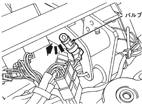
図 55 モニタランプバルブ取出し
