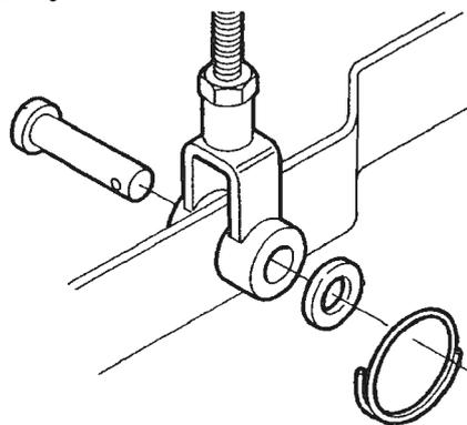
図 29 リフトリンク取付け取外し
