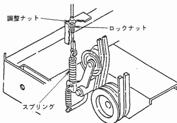
図 59 P.T.O ベルトテンションの調整
