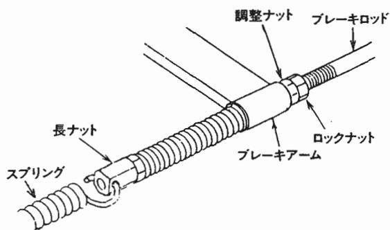
図 58 ブレーキペダル調整
