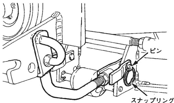
図 28 フロントリンク取外し
