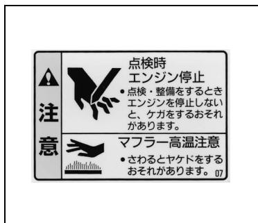
修理点検及び給油する場合は、エンジンの回転を停止してください。エンジンを停止せずに作業を行いますと死亡又は重傷を負う危険性があります。マフラー・マフラーカバー・排気管・シリンダ及びシリンダヘッド等は運転中及び停止直後は触らないようにしてください。
