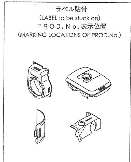
PROD.No. (15桁) のラベルは、ブロワハウジング、フューエルタンク、シリンダバッフル、ヘッドカバーのいずれかの見易い位置に貼付してあります。また、シリンダバッフルに打刻の場合もあります。
