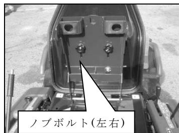
シート裏のノブボルトを緩め、シートをスライドさせて調整します。
