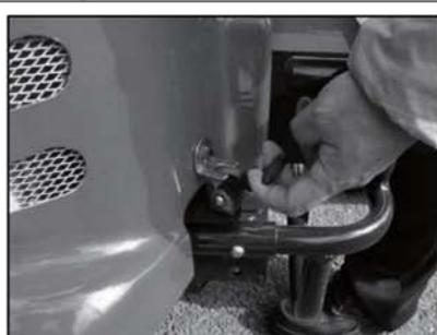
カバー後方（2箇所）にあるゴムキャッチを引き上げ外します。
