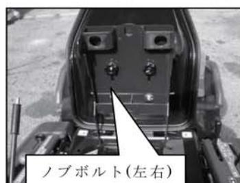
シート裏のノブボルトを緩め、シートをスライドさせて調整します。
