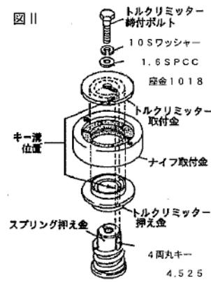
正しく組み込まれていれば、スプリング押え金上面にトルクリミッターフィット金が密着します。
