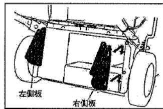
3. 防護カバー（側板も含む）が正しい位置に取り付けであるか確認して下さい。
