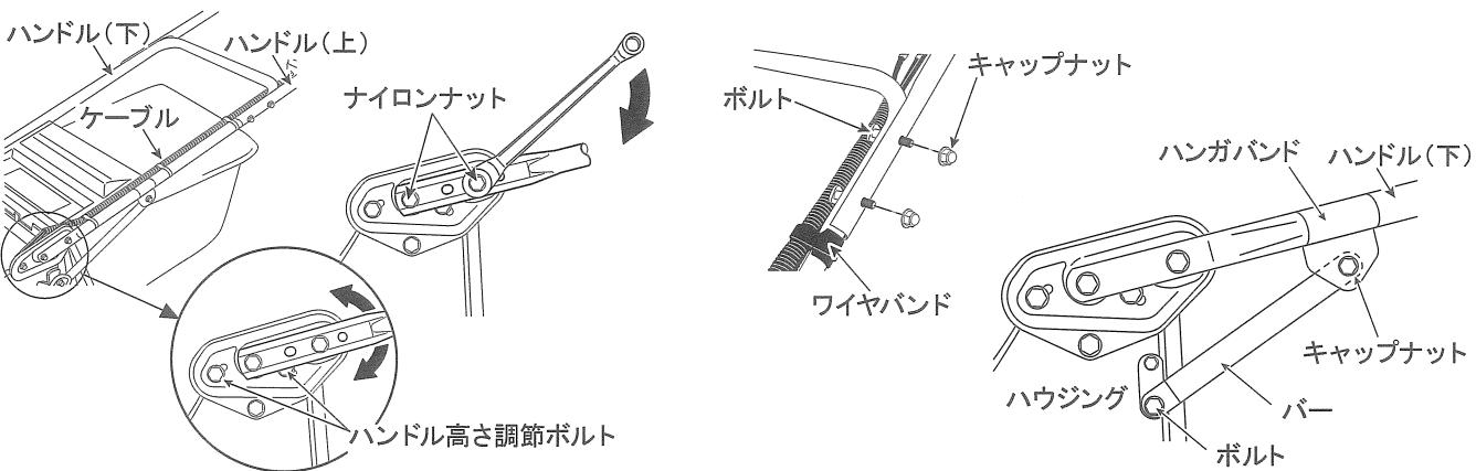
ハンドル高さ調節ボルトの締め付け位置に応じて、ハンドルは調節可能範囲内で無段階に調節ができます。
