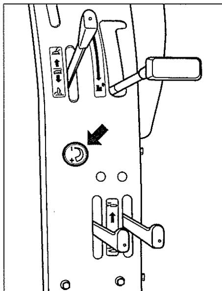
モアのゲージホイールの接地荷重を軽減し、ゲージホイールで芝を傷めるのを防止します。〔+〕の方向にノブを回すとゲージホイールの接地荷重が少なくなります。
