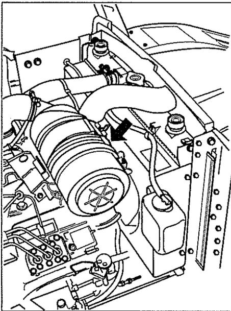
アウターエレメントは100時間ごとに掃除、6回掃除の後には交換してください。ホコリの多い所で作業するときにはもう少し短い間隔で掃除をしてください。規定時間になっていなくても1年間でエレメントを交換してください。インナーエレメントは、アウターエレメントの交換が3回毎か、1000時間毎のどちらか早い方で交換してください。
