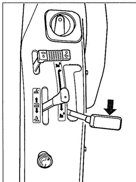
作業機への動力の入切はPTOレバーを使って行ないます。前方へ倒すと「入」になりPTO軸が回転します。作業時は、この位置でレバーを溝に引っかけ固定した状態で使用します。後方に引くと「切」になりPTO軸の回転が止まります。
