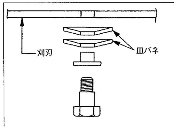
上図のように取付けてください。皿バネの方向に注意してください。(凹部を刈刃側にする) 刈刃の取付けボルトは下表に従い締め付けてください。
