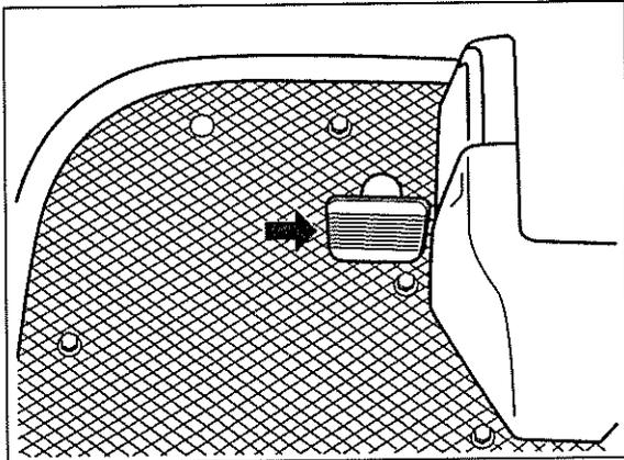
軟弱地などで前輪の片輪が空転した場合、両車輪を一体に駆動させる装置です。スリップして走行しにくいときに役立ちます。ペダルを踏むとデフロックが働き、ペダルから足を離すと解除されます。
