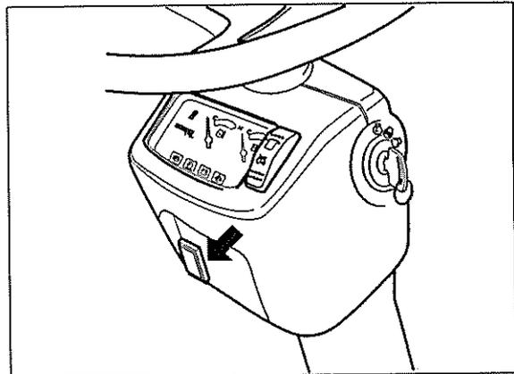
スイッチを押すとヘッドライトがつきます。ヘッドライト点灯状態にはライトスイッチにもランプがつきます。
