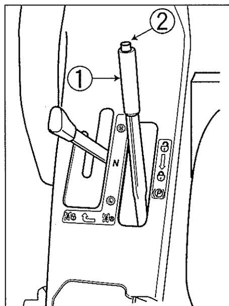
レバー①を引き上げると駐車ブレーキがかかります。解除するときはボタン②を押してレバーを下げてください。
