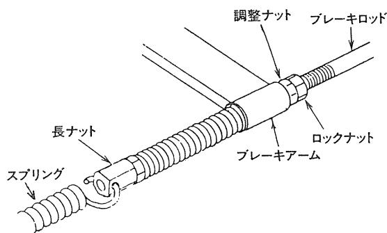
図 58 ブレーキペダル調整
