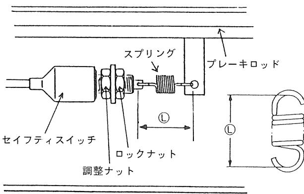
図 60 ブレーキペダルセイフティスイッチ
