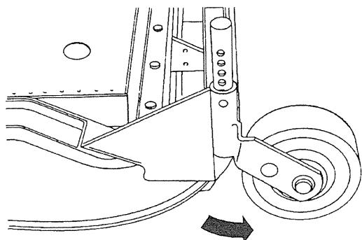
図36 ゲージホイル取付け
