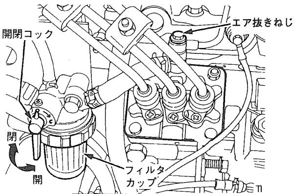
図 50 燃料空気抜き
