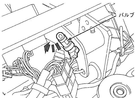
図 55 モニタランプバルブ取り出し
