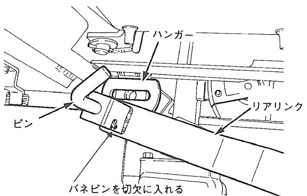
図33 リアリンク取付け
