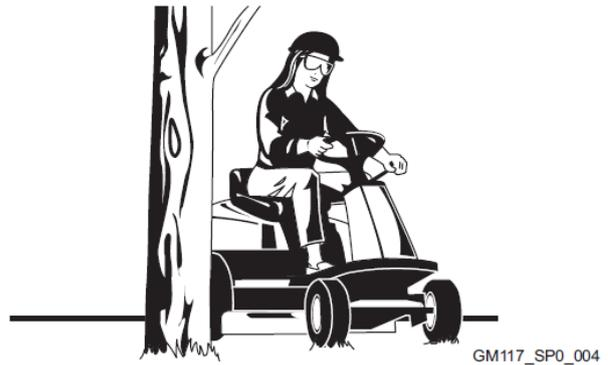
この機械には、危険が伴う可動部が多数あります。しかし、作業者が適切な操作を行っている限りは、安全に操作できます。デッキには、非常に鋭利なナイフが回転しています。機械が作動中は、決して手や足、体をデッキに近づけてはいけません。この機械にはオペレーターが安全に操作できるように、安全装置が付いています。この安全装置を解除したり、取り外したりしないでください。安全装置が機能していない場合は、直ちに販売店へ相談してください。
