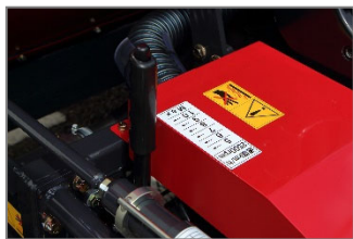
速度調節レバーで走行ペダルの踏み代が調整でき、作業速度を一定に保つことができます。
