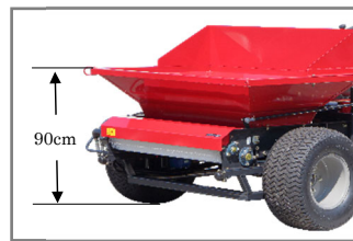
ホッパー位置が低く砂の搬入が楽々できるので、搬入作業の負担を大幅に軽減できます。
