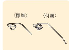
散布物によって標準スプリング(短)と付属スプリング(長)を使い分けることで、作業時の抵抗を低減し、より均一な散布ができます。
