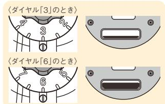
アジャストダイヤルの設定により、散布ゲート(前後シャッター)の開き具合が変化します。散布する肥料の量に合わせて設定することで、散布の均一化を図れます。
