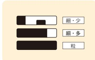
散布口切替板をスライドさせることで散布ゲート(左右シャッター)の形状が変わります。散布する肥料の量に合わせてスライドさせ、散布の均一化を図れます。
