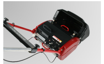
バッテリーを備えたコードレスタイプで機動性に優れます。本体フレームは軽量かつ丈夫なアルミダイキャスト製で、取り扱いやすく、運搬も楽々できます。
