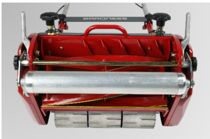
世界で認められた優れた切れ味のバロネスリールカッター（6枚刃）で、きれいな刈り上がりを実現します。6段階の高さ調整と簡易研磨ができる逆転スイッチ付です。
