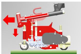
ダウンプレッシャー機構を採用することで、モアユニットの跳ねを抑制し、きれいな刈り上がりを実現します。
