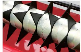
厚さ1.6mmの刃でルートマットと呼ばれる根の絡み合った固い層の透水性、通気性を改善します。
