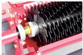
刃の中部分に切り込み曲げ加工した羽根
