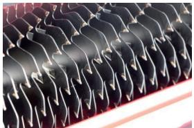
グリーン用チップ付タイプは、刃先のチップに超硬合金のタングステンカーバイド鋼を使用し、硬度が高く耐摩耗性に優れています。
