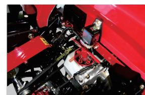
本機に装備されているリール回転（高速/低速）切替レバーで、刃の回転数を切り替えることで、サッチ回収量を調整できます。
