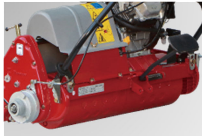
走行ドラムにはディンプルドラムを採用したので、高い駆動力を発揮します。
