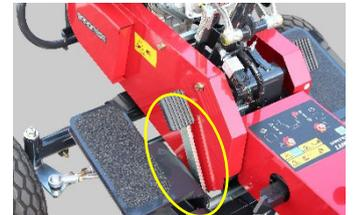
黄色枠のペダルを踏むとデフロックを掛けられます。傾斜地の作業でスリップを最小限に抑えることができます。
