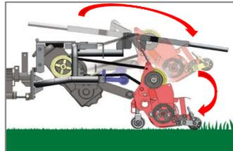
後モアが下がると、ベルトとプーリーが接触し、動力が伝達されます。
