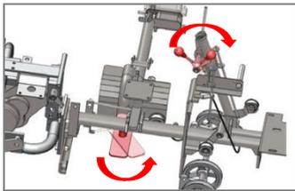
左右モアユニットの昇降と、リール回転レバーの「入・切」が連動しています。左右モアが上がっているとリール回転レバーが操作できないようになっています。
