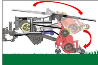
後モアが下がると、ベルトとブーリーが接触し、動力が伝達されます。
