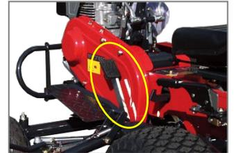
黄色枠のペダルを踏むとデフロックを掛けられます。傾斜地の作業でスリップを最小限にすることができます。
