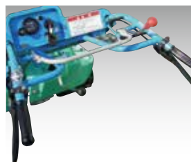
操向クラッチがブレーキと連動しているため、旋回が楽々できます。
