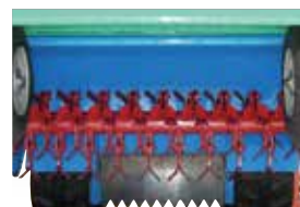
ハンマーナイフは熱処理を施した特殊強靱鋼を使用し、良く切れ、耐久性があります。取り付けはナイフが逃げるフリー構造です。
