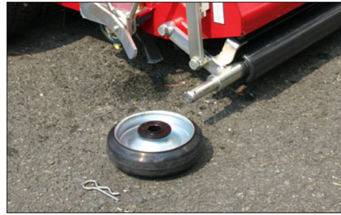
・移動車輪はピン1本で簡単に取外すことができます
