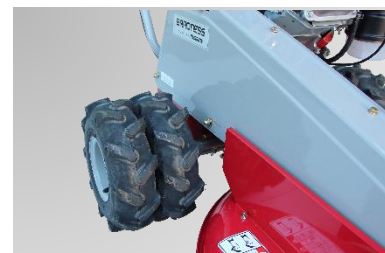
後輪タイヤは、ラグ付きダブル車輪を採用したため、傾斜地で安定した作業ができます。
