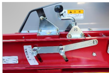
刈高の調整は、ロータリーデッキ上部にあるハンドルを回し、目盛りに合わせることで調整できます。
