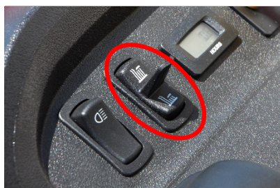
インパネにある電動刈高スイッチを操作することで、刈高を簡単に調整できます。
