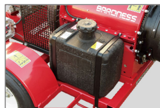
燃料タンク24Lで、長時間の作業が可能です。
