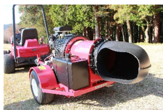
ノズルは360度回転させることができ、進行方向を選ばず作業ができます。
