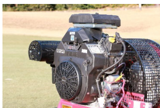
27HPのガソリンエンジンを搭載、十分な風量を送り出します。
