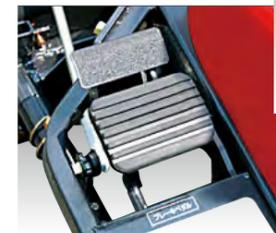
油圧ブレーキの他、後輪2輪に大型ドラムブレーキを採用しています。また、パーキングブレーキとしてはもちろん、作業中のダイナミックブレーキとしても高い性能を発揮します。
