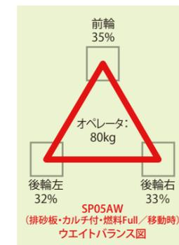
適正な3輪のウエイトバランスを実現し、転倒の危険を防止します。また、同時に駆動力の確保もしています。
