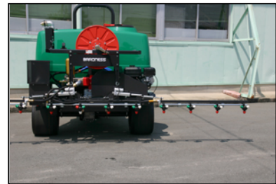
三ツ折ブームは左右別駆動の電動開閉方式を採用。最大散布巾は3.6mです。
