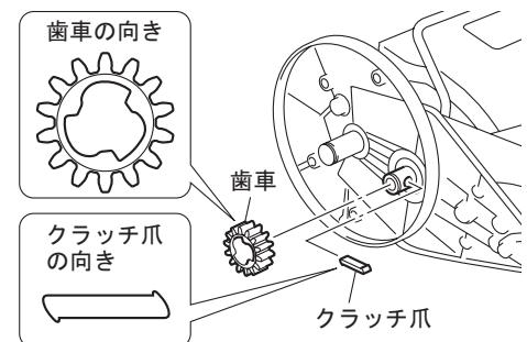
⑪ 歯車とクラッチ爪、車輪を組付けます。組付けの際、歯車、クラッチ爪の向きを間違えないでください。
