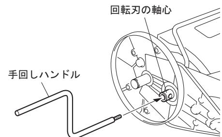
⑧ 「[3-3] 刃合せの状態を確認する」を参照し、回転刃と受刃の左部・中央部・右部の3カ所で刃合せを確認します。
