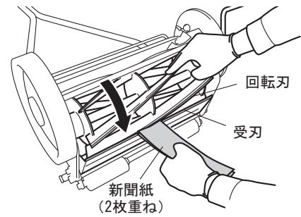
⑨ 手回しハンドルを時計方向（回転刃を逆回転）に回しながら研磨剤を新聞紙が切れる場所へブラシで塗ります。刃の全面がムラなくかみ合うようになるまで続けてください。
