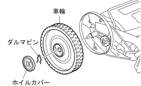
③ 齒車とクラッチ爪の取付け向きをよく確認した上で外してください。
