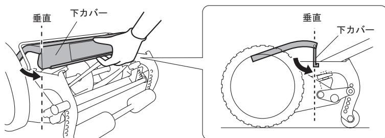
③ 下カバーが受刃調整ツマミの内側に入るようにカバーを「カチッ！」と音がするまで下方向へ押込んで閉める。
