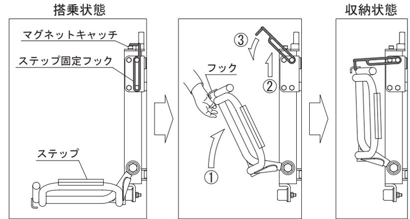
ステップを持ち上げます (①)。この際、ステップは底面のパイプ部分にて保持するようにしてください。ステップを上げた状態で、ステップ固定フックを引上げ (②)、機械後方側へ倒すようにしてください (③)。
