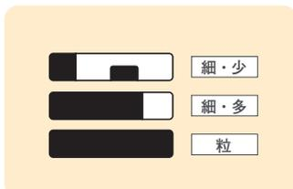
散布口切替板をスライドさせることで散布ゲート（左右シャッター）の形状が変わります。散布する肥料の粒径に合わせてスライドさせ、散布の均一化を図れます。
