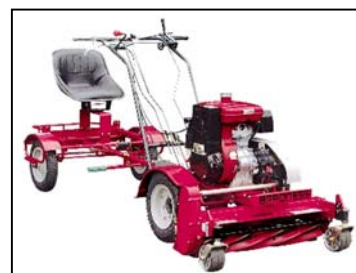
オプションの簡易乗用装置（サルキー）を装着し、乗用型としても使用できます。
