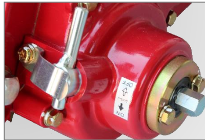
リール回転ON・OFFの切り替えは、フレームカバー小にあるレバーで行います。
