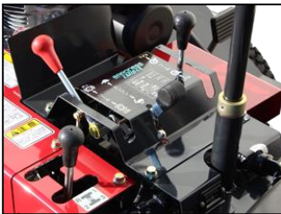
操作レバー類がまとめて配置しており視線の移動が少なく、刈り込み作業が快適に行えます。
