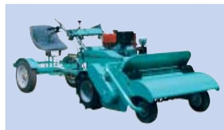
HST採用でチェンジ切り換えなく、前後進、速度調整がワンレバーで簡単に操作できます。河川の堤防、果樹園、工場、グラウンド、平坦地から傾斜地まで、草の種類を問わず能率的に草刈りができます。セルモーター付エンジンのため、始動が容易です。
