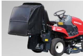
集草機は大容量の320L。開閉は電動式を採用し排出作業がとて容易です。満杯になるとブザーでお知らせします。
